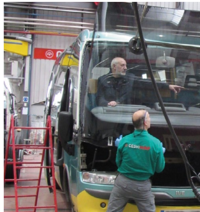
► Colocación de una luna pegada
