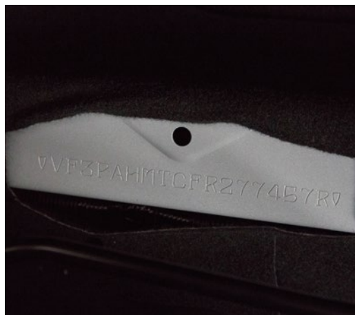
► Número identificativo grabado y troquelado, y retroquelado, derecha
