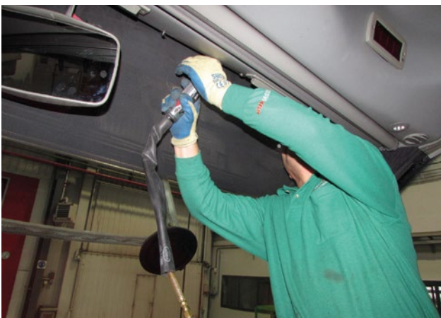
► Corte del cordón adhesivo desde el interior
