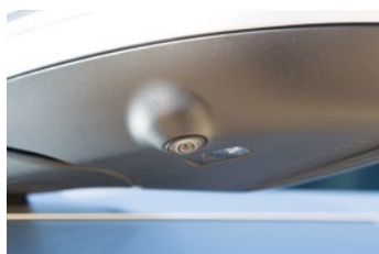
► Sistema de vigilancia del entorno del C220
